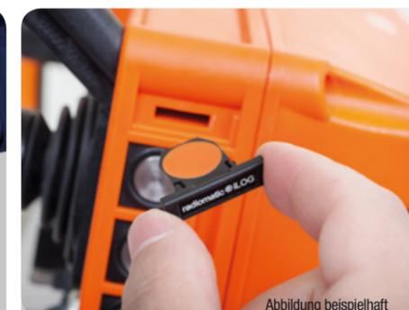
radiomatic® iLOG zur schnellen Aktivierung eines Ersatzsenders.
