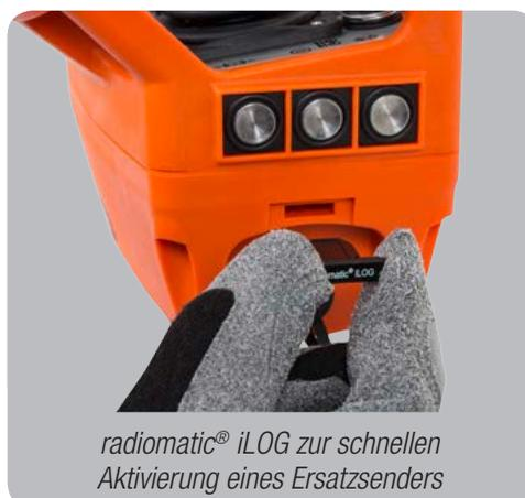
radiomatic® iLOG zur schnellen Aktivierung eines Ersatzsenders
