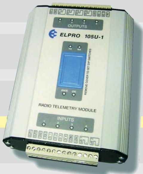
Das 105U Funkmodul ermöglicht die Übertragung von einzelnen Signalen wie Digitalsignalen, Analogwerten oder Impulsen per Funk. Geber oder SPS lassen sich direkt an das Funkmodul ankleben. Sollten die vorhandenen Ein- und Ausgänge nicht ausreichen, so ist eine Erweiterung durch die Gerätereihe 105S möglich. Die Anbindung erfolgt via RS-485.
