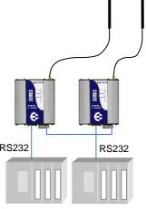
REDUNDANT PAIR WITH REDUNDANT HOSTS USING RS232 messages.
