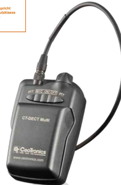
darf auf weitere Funktionen programmierbar. Der Drehknopf auf der Oberseite ist ebenfalls mit einer Doppelfunktion belegt. Er ist ON/OFF-Schalter und individueller Lautstärkeregel zugleich.
