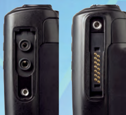
2-poliger Anschluss (links) und 14-poliger Universalanschluss (rechts)
