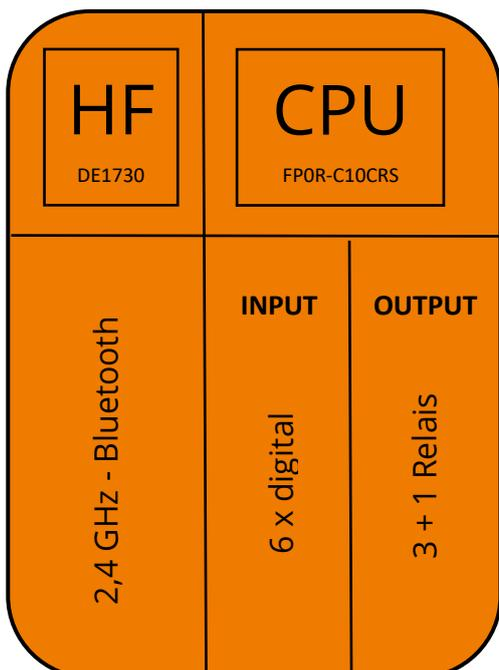
Das Modul ist Teil der Modulreihe A und verwendet die Funktechnologie Bluetooth auf 2,4 GHz. Die verwendete Panasonic SPS der Serie FP0R ist ausgestattet mit 6 digitalen Eingängen und 3+1 Relais - ein Relais ist zur Funkstreckenüberwachung in Verwendung. Es ist konzipiert zur Hutschienenmontage und 24 V DC Versorgung.
